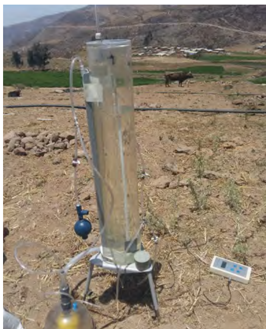
» Figura 2.3: Izquierda: Evaluación de la conductividad hidráulica del suelo en la cuenca del río Lurín mediante un infiltrómetro de campana. Imagen: J. Bondy. Dere- cha: estación de precipitación RSN05 en el distrito de San Damián a 4 455 metros sobre el nivel del mar. Imagen: S. Schroers.
